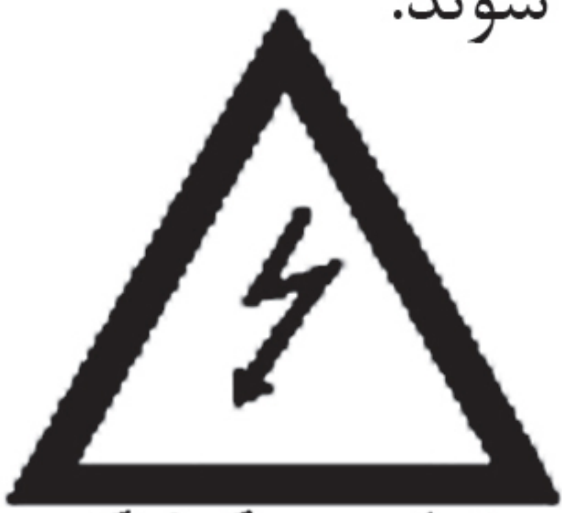
خطر برق گرفتگی
